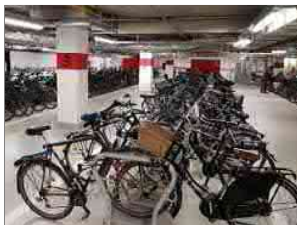
Hoch-Tief-Einsteller beidseitig (Nutzung von beiden Seiten möglich; hohe Flächenausnutzung!)
